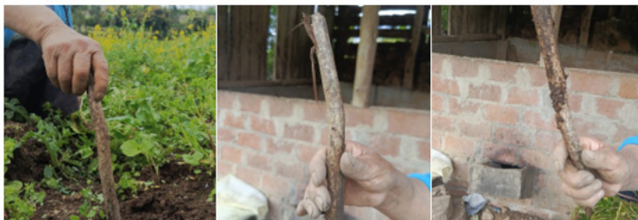
Figura 14. Determinación de la humedad del suelo.
