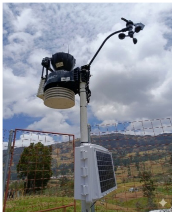
Figura 2. Estación meteorológica automática.
