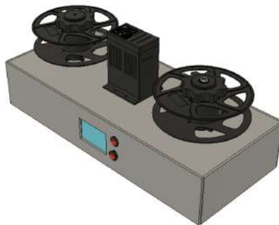
Figura 4. Diseño 3D de la extrusora de filamento PET
