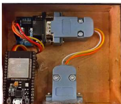
Figura 4. Conexión del hardware del sistema embebido.
