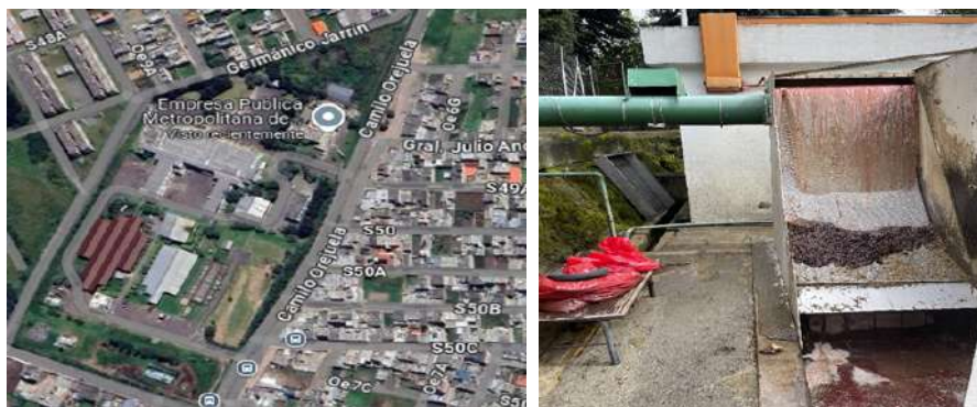
Figura 1. Empresa de Rastro de Quito. Tamiz curvo de barra auto limpiante.
