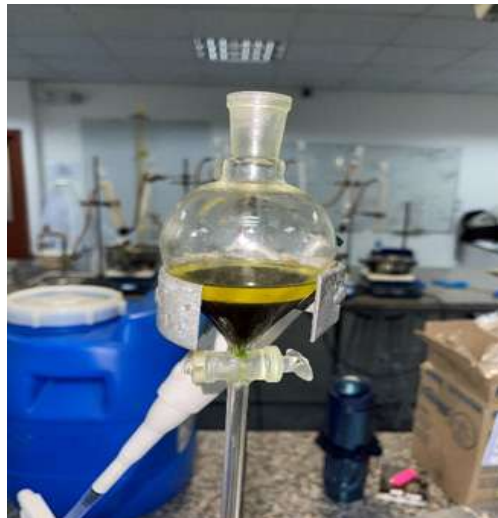
Figura 6. Separación de fases en embudo de decantación.
