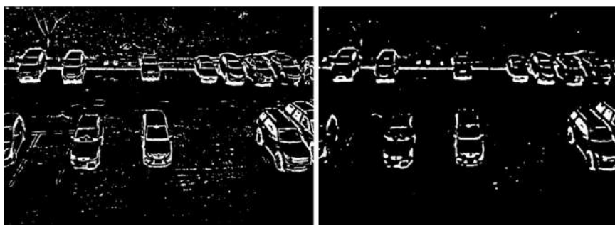
Figura 7. Eliminación de ruido aplicando filtro de mediana
