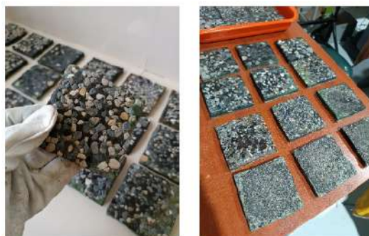
Figura 3. Adoquines en sus diferentes proporciones plástico: áridos
