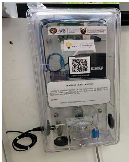
Figura 5. Prototipo de sismógrafo instalado
