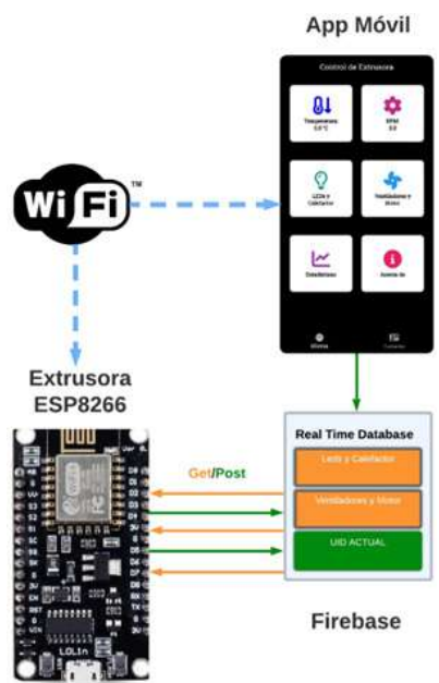
Figura 6. Arquitectura que utiliza el ESP8266 la comunicación entre la extrusora de filamento PET y el aplicativo móvil
