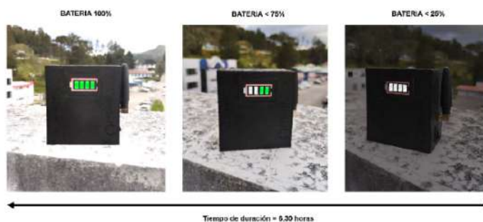
Figura 12. Pruebas de duración de la batería
